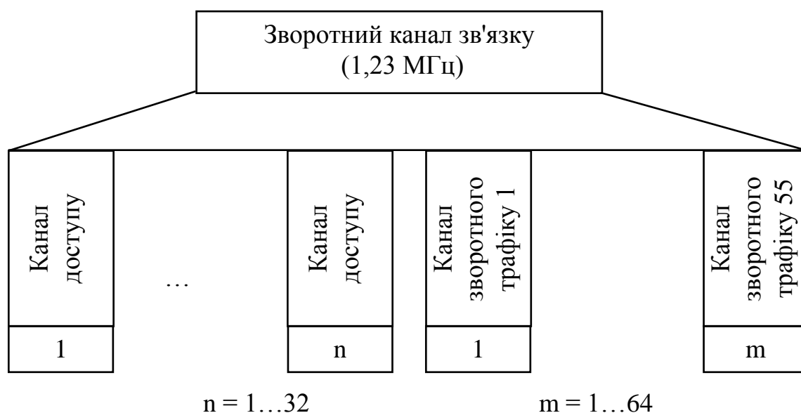
Рисунок 4.12 – Структура зворотного каналу зв'язку системи cdmaOne
